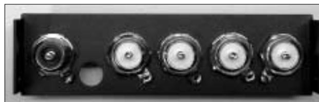
Lage der Masselötösen. Die Massen von Buchse C und D werden mit SK6G auf der Platine verbunden.
